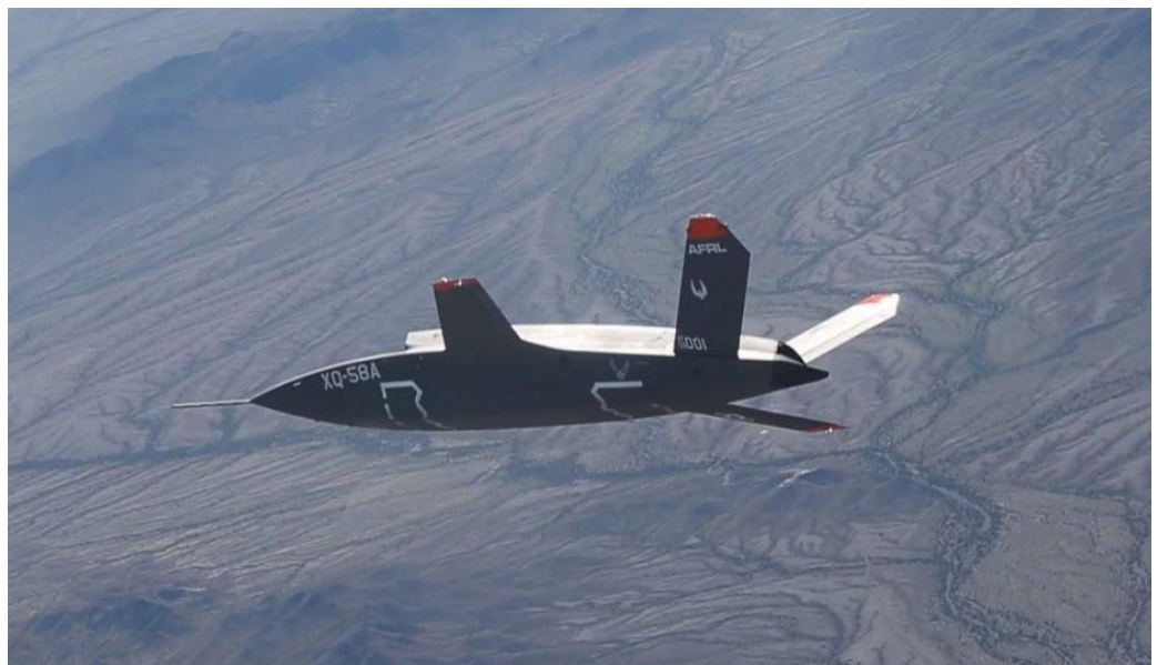
图表 27: XQ-58A 是美国开发的新型无人作战系统，该机设计用于与载人战斗机一起飞行并自动导航
