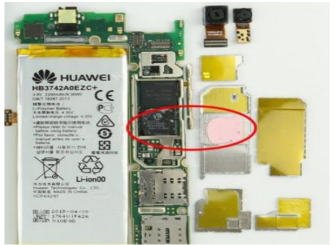
图表 6: 智能手机硅胶散热
