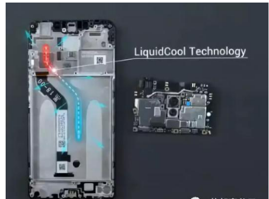
图表 27: 小米 Poco F1 水冷散热
