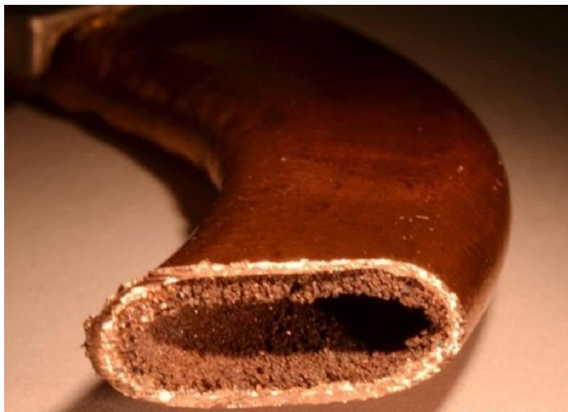
图表 23: 铜管内部毛细结构
