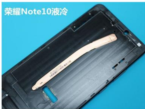
图表 28: 华为荣耀 Note10 液冷散热
