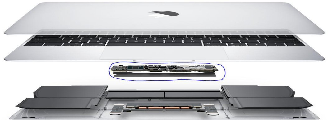
图表 49: 苹果电脑采用高导热石墨膜散热
