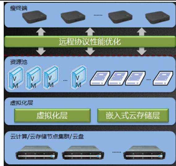
图表39：VDI架构示意图
