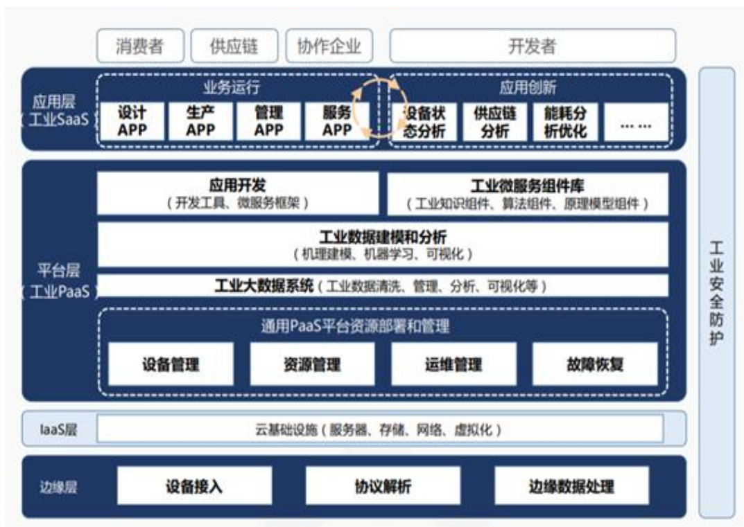
图 59：工业互联网平台功能架构图
