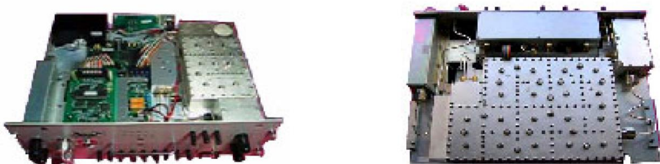
图表 9: 射频子系统是多类器件的集成,总方案由设备商定制
