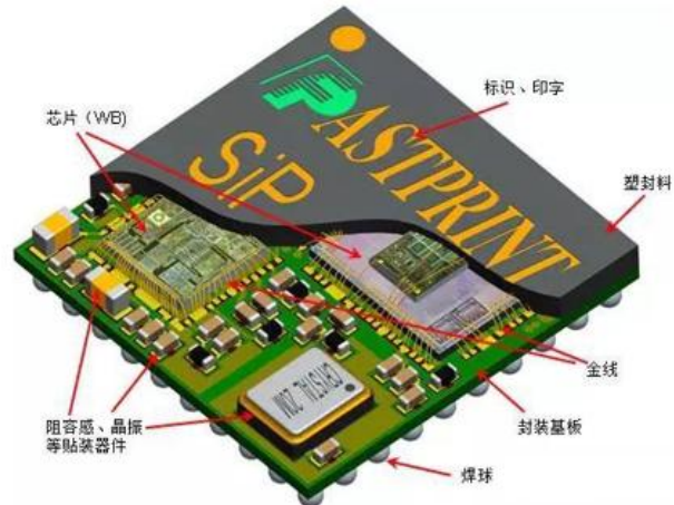
图表 55: 多芯片 SiP 封装结构示意图
