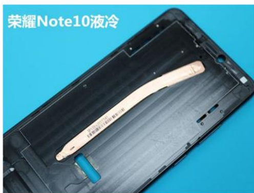
图表 130: 华为荣耀 Note10 液冷散热
