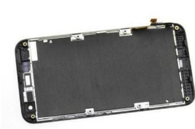
图表 118: 石墨贴散热
