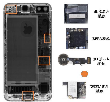
图表 59: iPhone 7plus 内部 SiP 模组渗透增大
