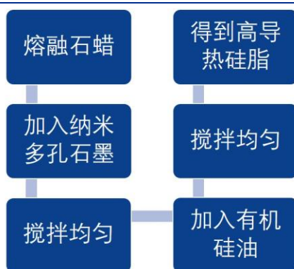
图 41：石墨相变导热硅脂的工艺流程图
