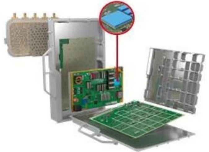
图 14：导热硅胶片在基站中的应用
