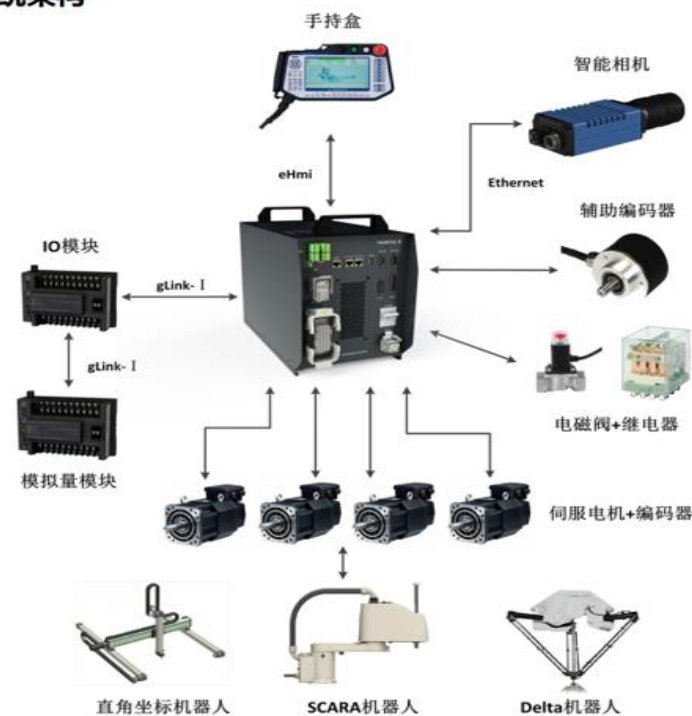
控制器驱控一体化结构图
