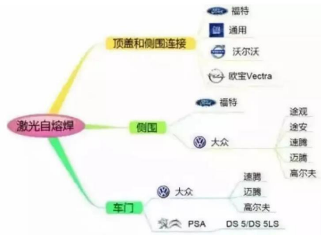
图：激光自熔焊在汽车工业的应用
