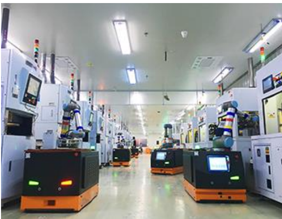
图 37: 晶盛机电帮助客户搭建的无人硅片抛光车间
