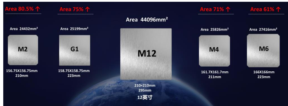
图 33: 中环股份推出M12大尺寸硅片
