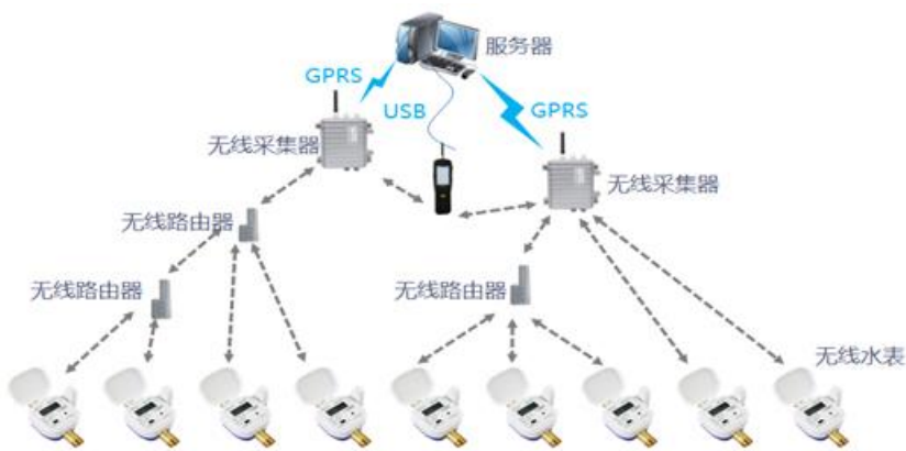
图 16：公司智慧供水平台结构图
