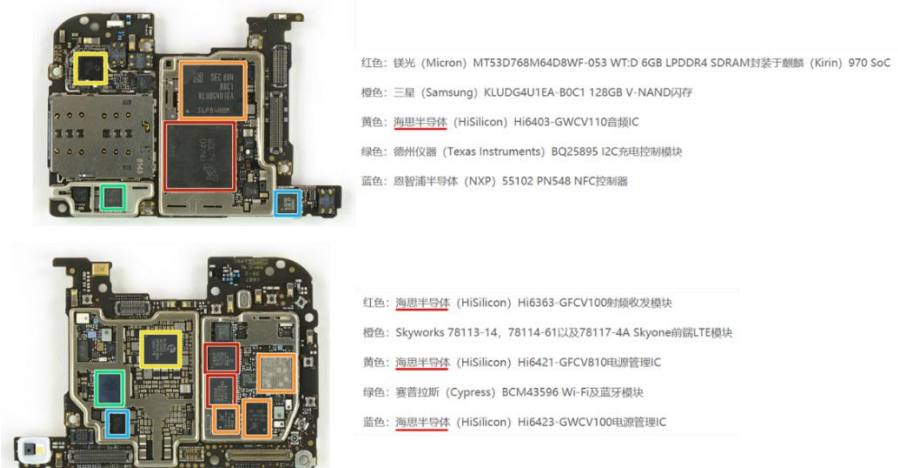
图表 7: 华为 P20 Pro 拆解、主要芯片构成
