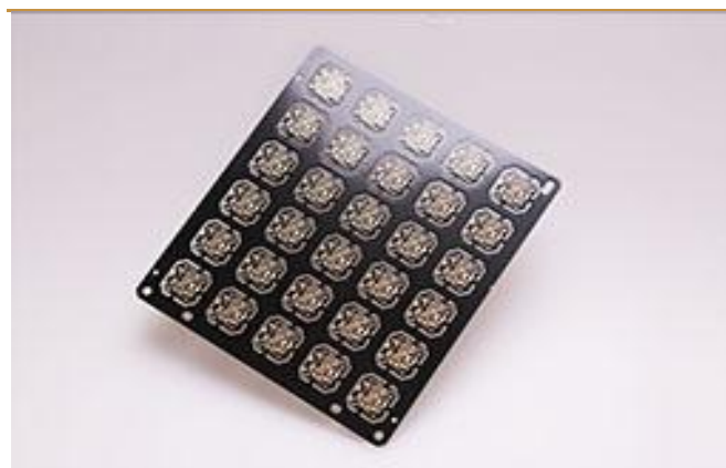
图 7: 高阶四层 HDI 板示意图
