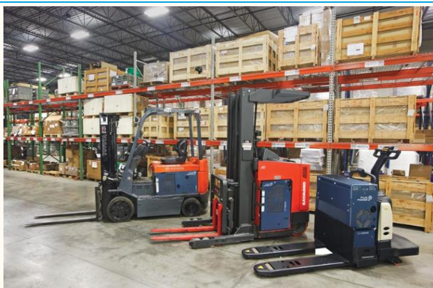
图表 72: Plug Power 燃料电池叉车 (GenDrive)
