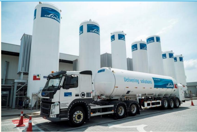
图表 81: Linde 气氢拖车
