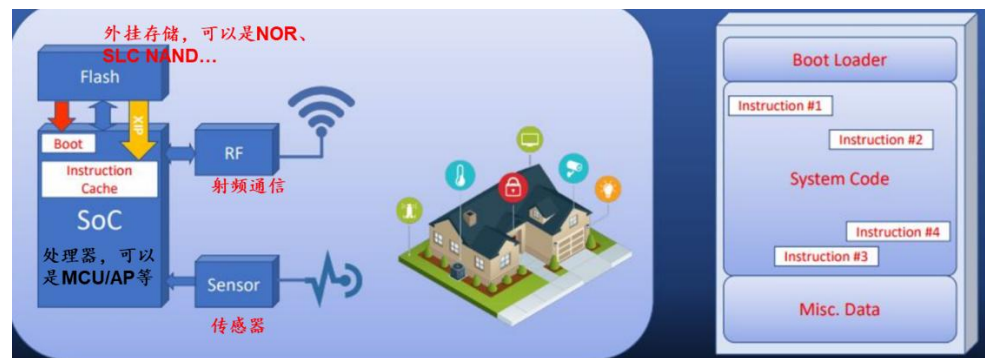
图表 1: 一个典型的物联网模块包括处理、外挂存储、射频通信以及传感器
