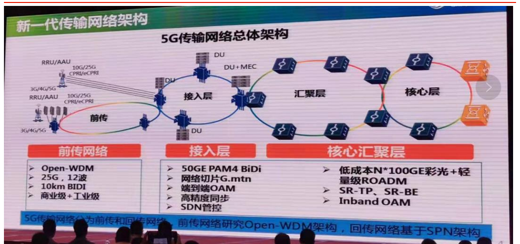
图表2： 5G 时代移动传输网络结构
