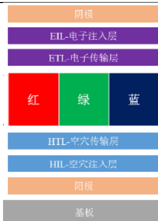
图表 1：OLED 面板显示原理示意图
