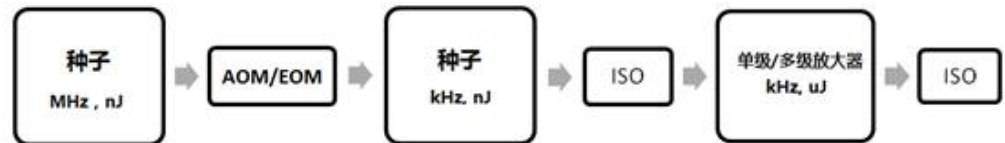
图表 10: 皮秒激光器工作原理
