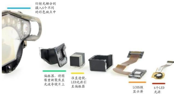
图 72: Magic Leap 1 光学部分
