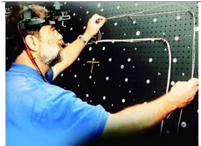
图 72: 波音工程师使用抬头透视装置指导线束安装
