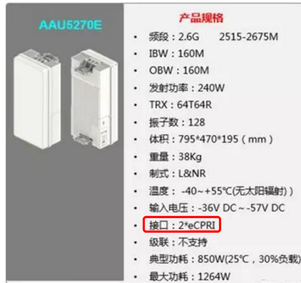
图 3：华为 160MHz AAU5270E 产品规格，注意接口为 2*eCPRI
