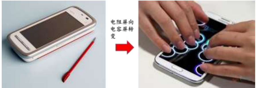
图 6: 电阻屏向电容屏的转变
