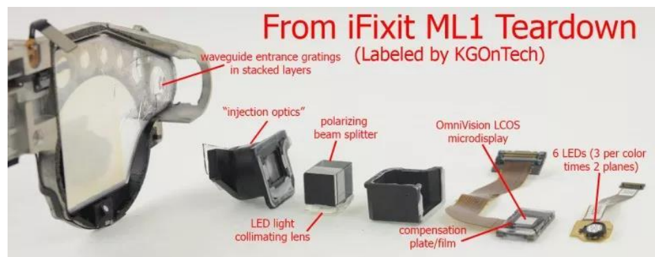
图表 11: Magic Leap One 光学元件拆解
