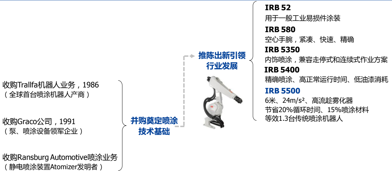
图表 7: 横向并购打造技术核心、推陈出新引领行业产品发展
