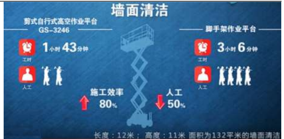
图 5：以墙面清洁为例，高空作业平台相比脚手架施工效率提升 80%
