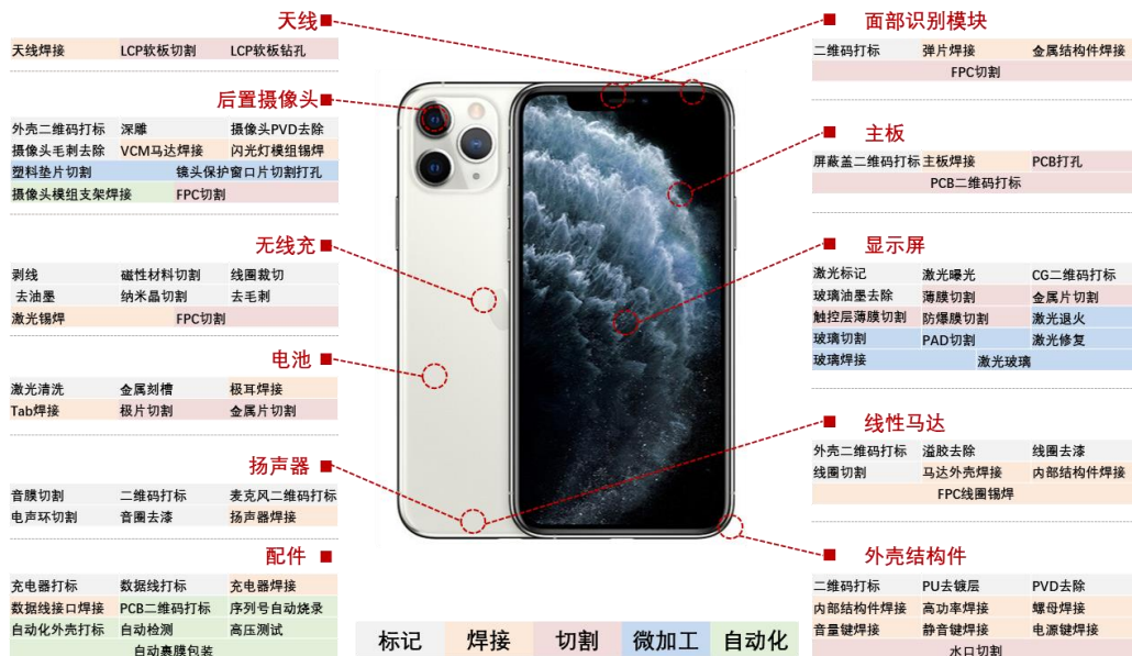
图 11：激光设备可用于手机加工的多个零部件
