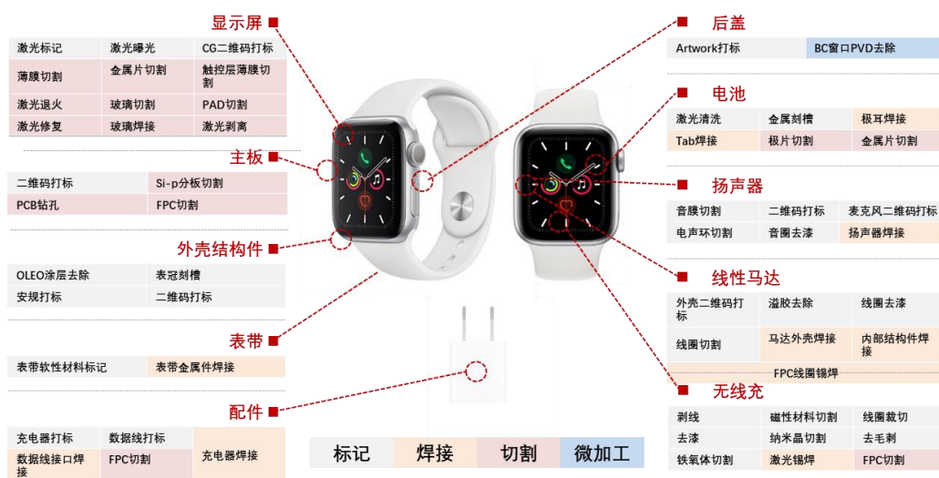
图 12：激光设备也用于智能手表加工的多个零部件
