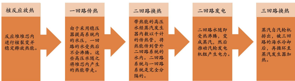
图表21. 压水堆核电站发电流程
