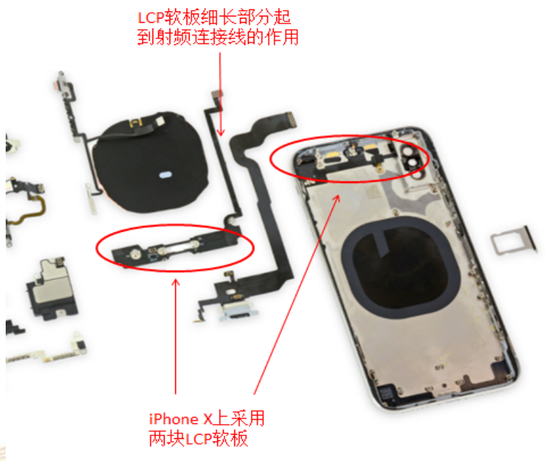
图： iPhone X上下各有一片LCP材料的FPC用于天线连接
