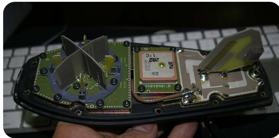
图：某车型鲨鱼鳍天线拆解
