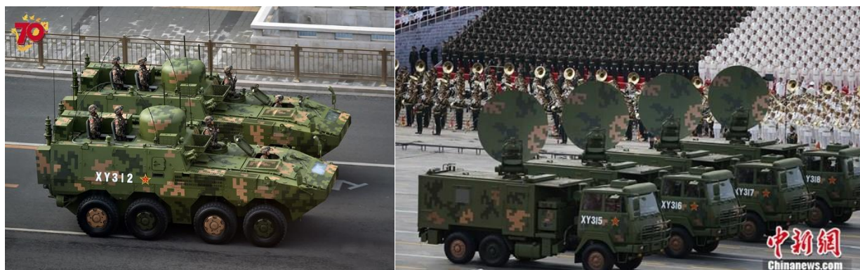
图 42：参考 2015 年胜利日阅兵的信息支援模块：轮式装甲无线电接入节点车、卫星通信车载站
