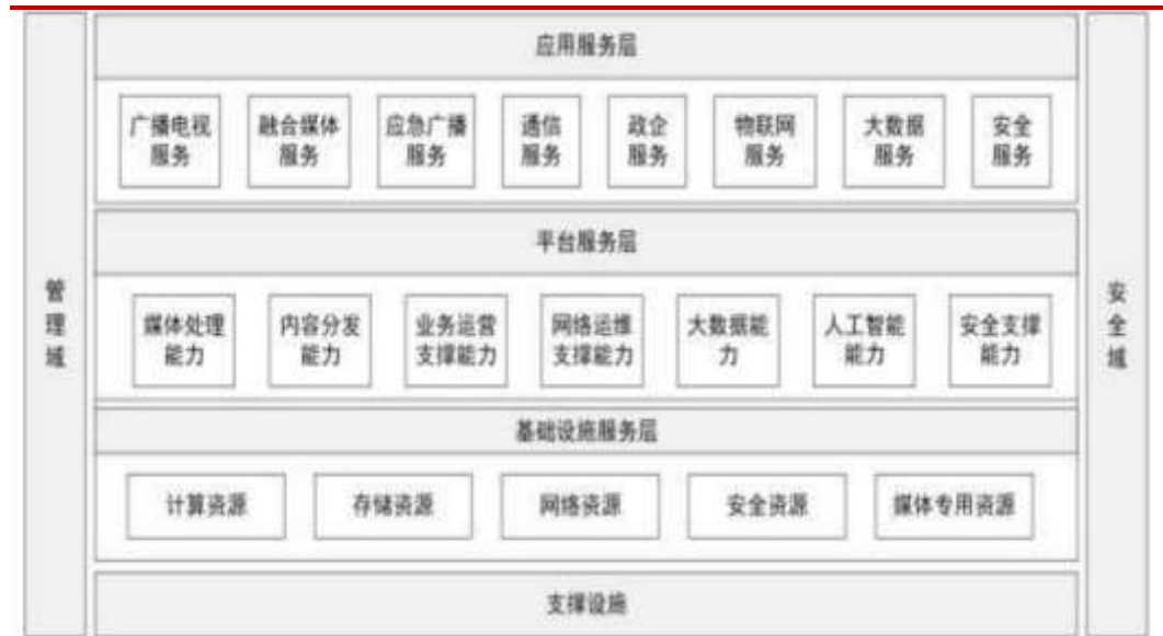
图 10 智慧广电有线网络服务云技术架构示意图
