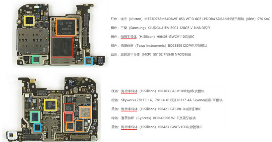
图表 19: 华为 P20 Pro 拆解、主要芯片构成
