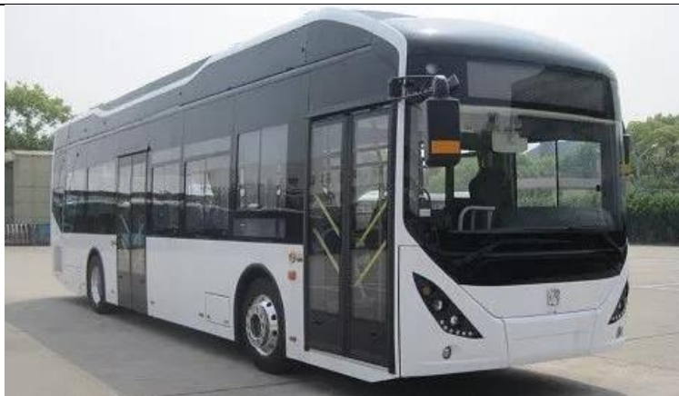
图 36：申沃牌 SWB6128FCEV01 型全低地板燃料电池城市客车
