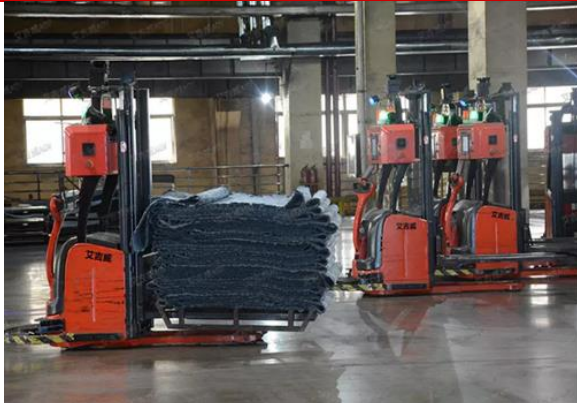
图 41 智慧工厂——AGV 无人叉车
