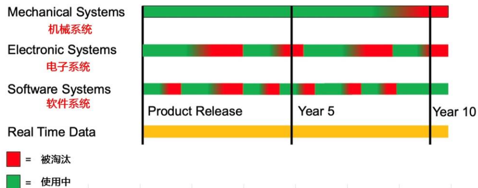
图15：汽车中软件系统的迭代速度比电子系统快1.5倍，比机械系统快6倍
