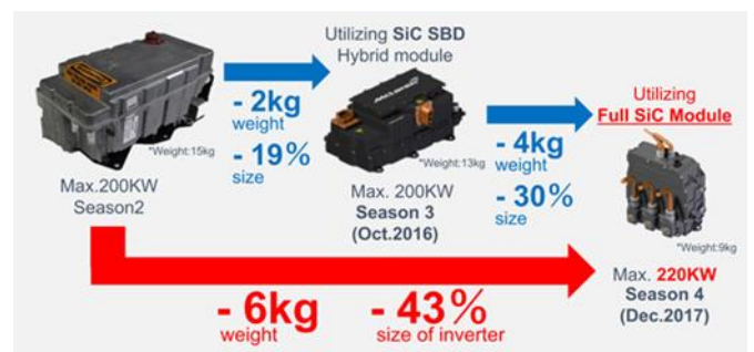
图 20: 罗姆的 SiC 赛车用逆变器明显降低重量及尺寸
