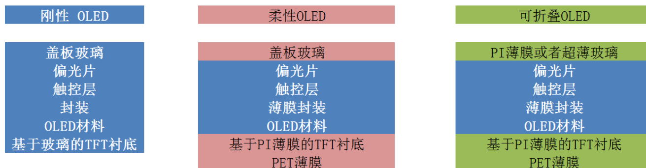
图 2-2: CPI 和 UTG 薄膜有望替代柔性 OLED 覆盖玻璃和 PET 基薄膜
