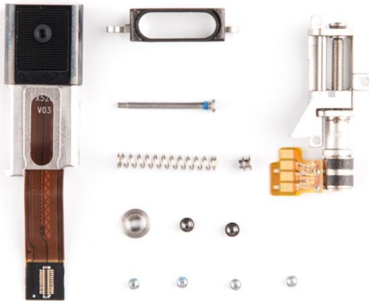
图 17 vivo NEX 升降摄像头结构
