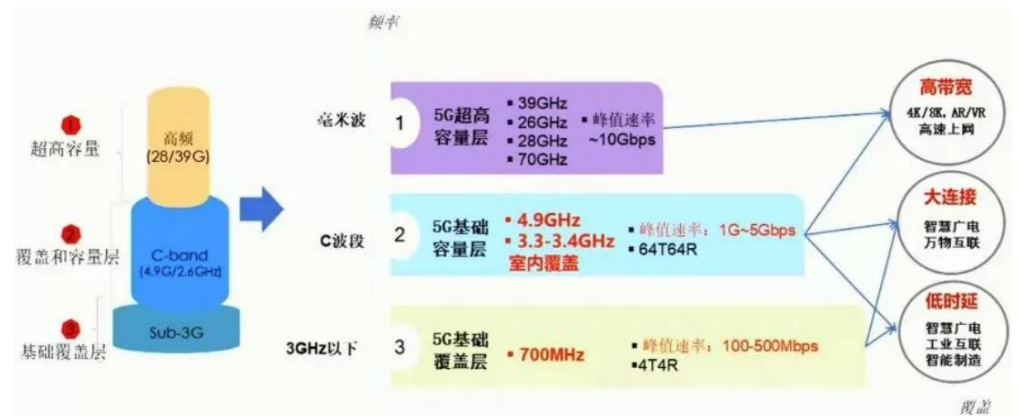
图4：广电移动通信网络多频组网方案
