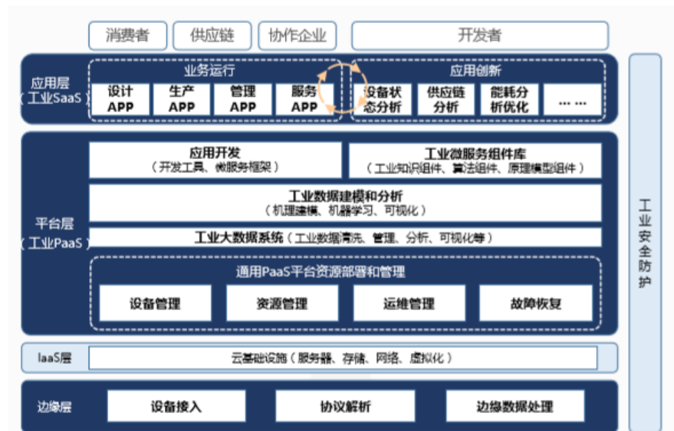
图 3：工业互联网平台功能架构图
