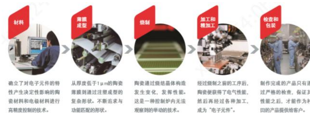
图 25：村田从材料到产品的一体化生产机制
