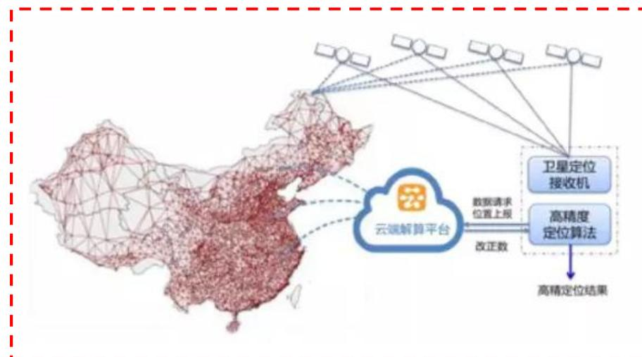
为了应对不同场景，将高精度GNSS引入移动通信网络控制面，不仅支持单播改正数的播放还支持广播的方式。
