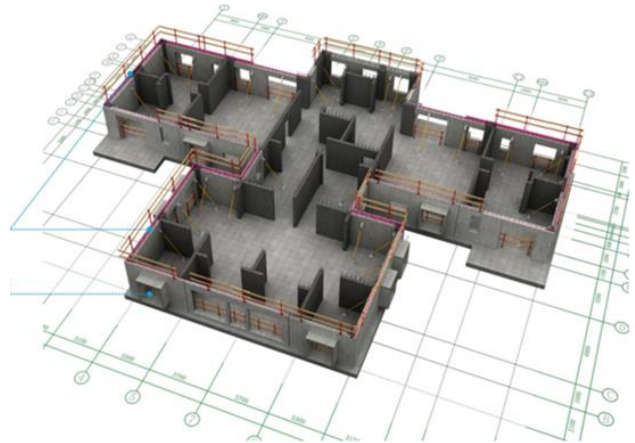
图 27：第六代体系——预制剪力墙+现浇剪力墙
