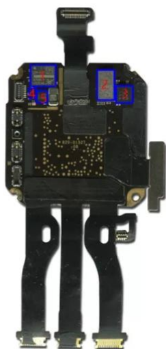
图 38：Apple Watch S5 主板正面 IC
