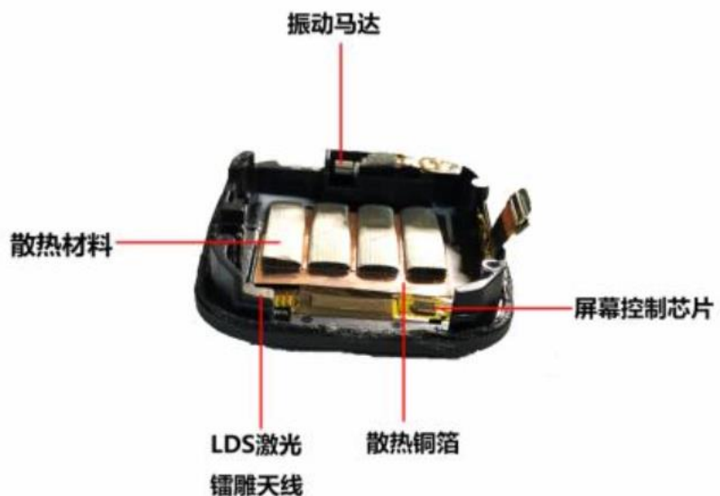
图 28：小天才手表游泳级防水原理
