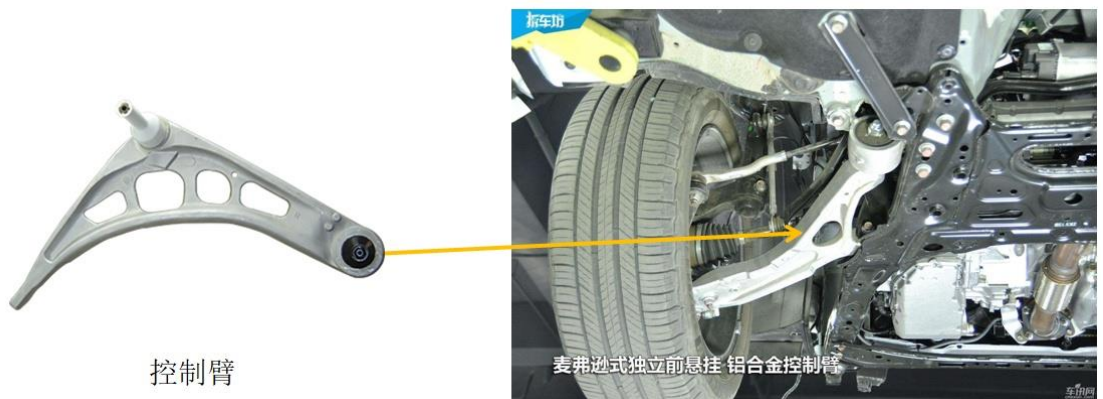
图表 79. 悬架系统轻量化--铝合金控制臂
