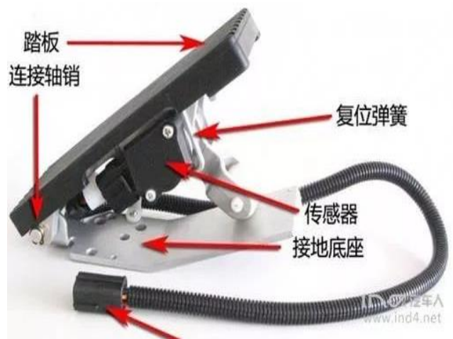
图表 71. 电子油门结构示意图
