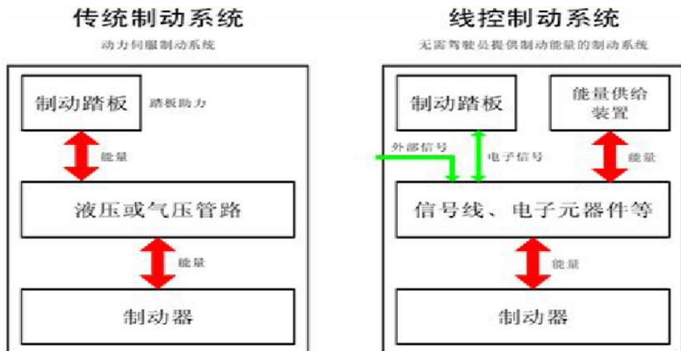
图表 44.传统与线控制动系统比较
