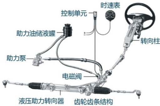
图表 57.电液助力转向系统结构示意图
