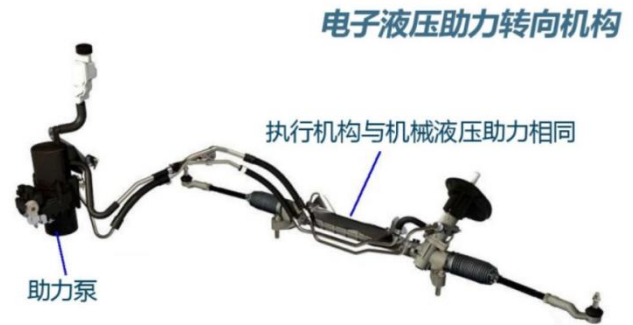
图表 58.电动助力转向系统结构示意图
