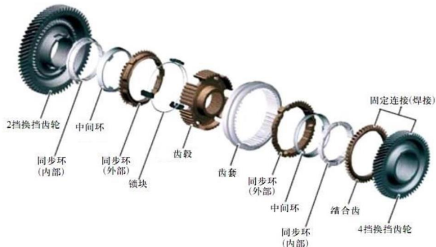
图 1：汽车变速器用同步器主要构成
