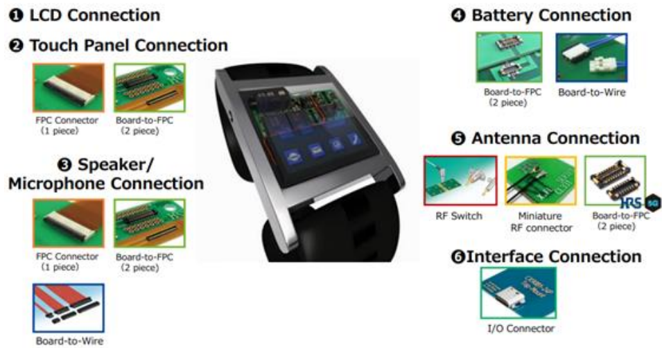
图 27：可穿戴（手表）里面连接器的应用
