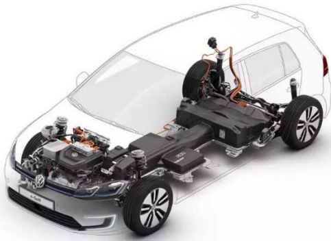
图 74 基于大众 MQB 平台打造的 e-Golf 底盘布局
