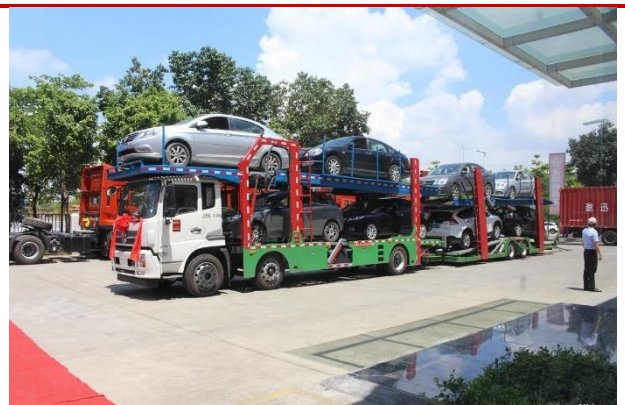
图 84 中置轴车辆运输车 (运力 8 辆)
