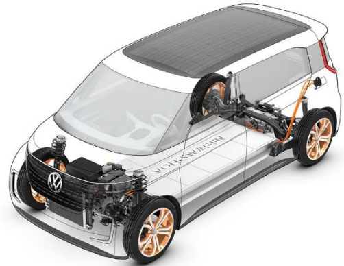
图 75 基于大众 MEB 平台打造的 BUDD-e 底盘布局
