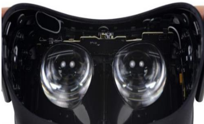
图 38 Oculus Rift 头戴设备组件
