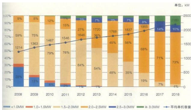
图 44：国内大容量机组占比不断提升
