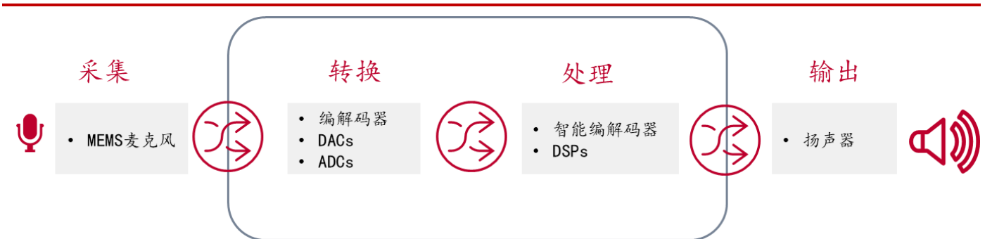
图 16: 音频 IC 在声学链中处于关键位置
